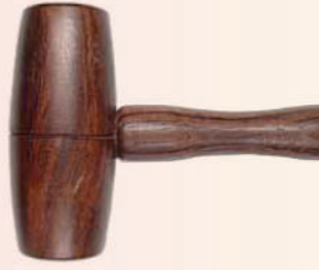
الشكل (١٤٢): مطارق متنوعة ومتعددة ذات رؤوس خشبية مناسبة للحفر.
