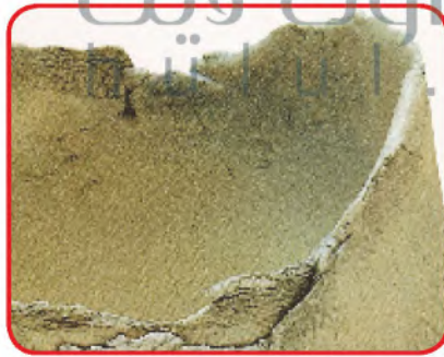
شكل (١١٠): يوضح نتائج أخطاء التجفيف ( تشقق ).
