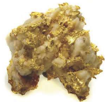
الشكل 36-4 تتكون عروق الذهب في الكوارتز عندما يبرد المحلول الحراري المائي.
