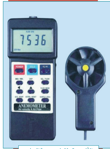
الأنيمومتر لقياس سرعة الرياح
